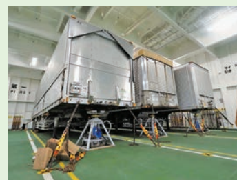
荷崩れ防止のため、コンテナや貨物が動かないように固定されている
