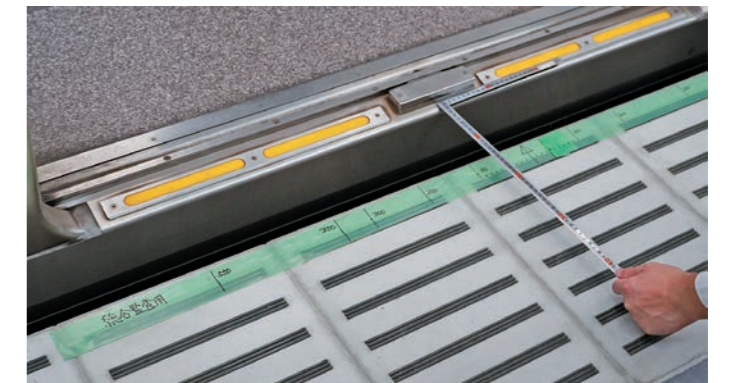
車両ドアの中心と可動柵の中心を測定し、車両の停止位置にずれがないことを確認する
