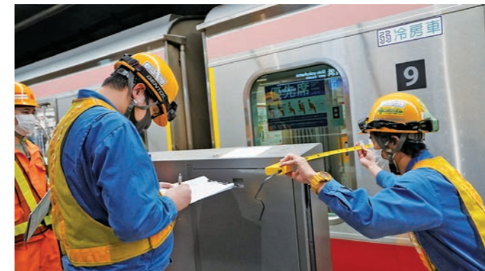
全ての車両ドアと可動柵の隙間を測定する
