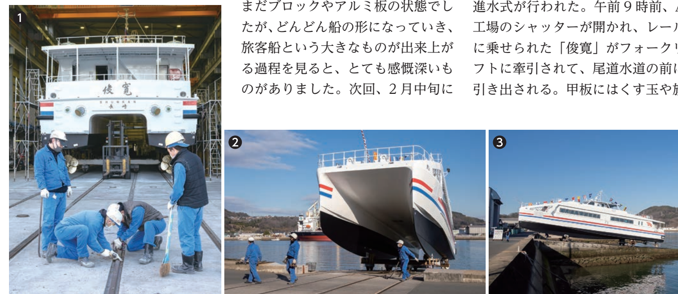
①船体引き出し前にレールを確認 ②双胴船の構造がよくわかる ③水面近くまで船体を移動
