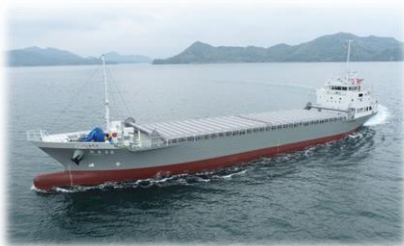
「國喜68」（次世代内航貨物船） 令和5年5月竣工 電動・デジタル機器を搭載した連携型省エネ船（SIM-SHIP） 鋼製、499総トン、一般貨物船、載貨重量1.691DWT
