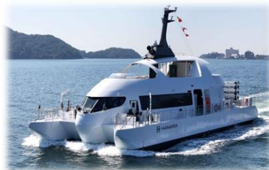
「HANARIA」（水素燃料電池船） 令和6年3月竣工 水素とバイオディーゼル燃料を活用した国内初の旅客船 鋼製、238総トン、旅客定員103名（1.5時間未満の場合）、小倉・関門周辺航行
