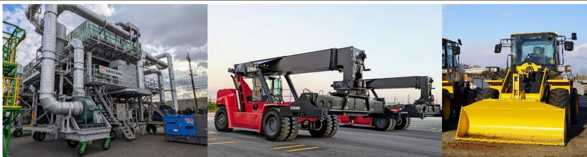
写真【左】：ホッパー（木質ペレットをコンテナに充填する際に使用）
