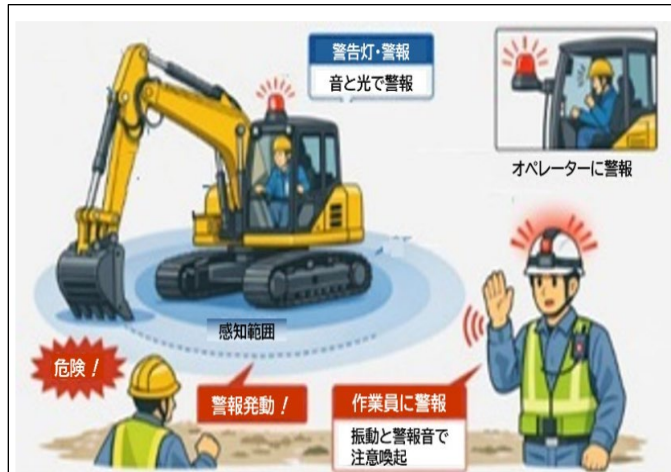
図-1 重機接触防止装置のイメージ
