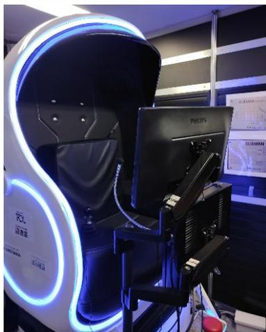
タワークレーン遠隔操作システム
