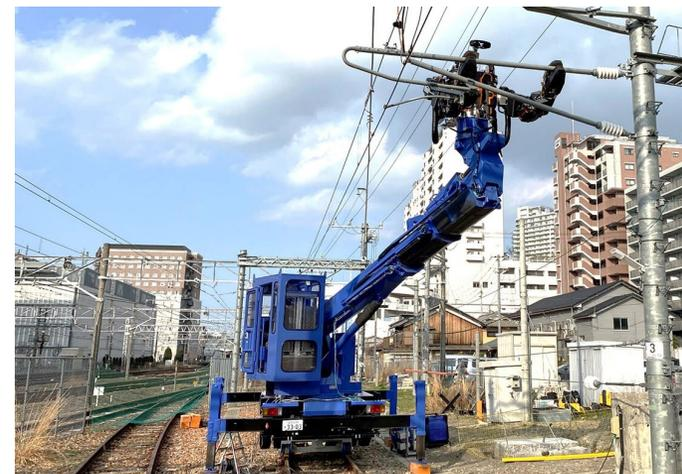
鉄道電気設備作業におけるロボット試行
