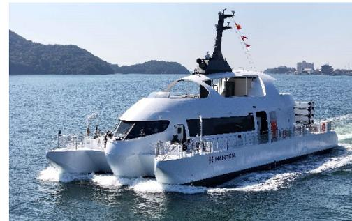
日本で初めて水素燃料電池、リチウムイオンバッテリー、バイオディーゼル燃料から推進エネルギーを選択し航行
