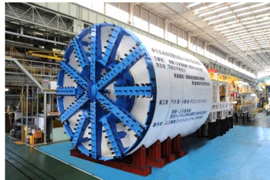
写真 1.1.4-2 西谷トンネル工事で使用した シールドマシン
