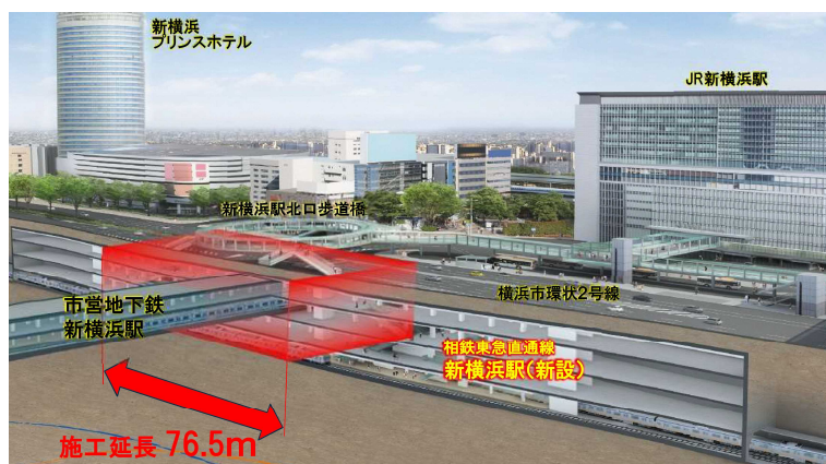
相鉄・東急直通線 新横浜駅のアンダーピニング施工箇所
