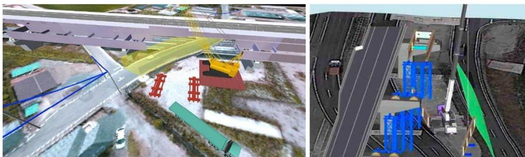
図3. 1 2 橋梁上部工の架設計画の検討において活用する BIM/CIM モデルの例
