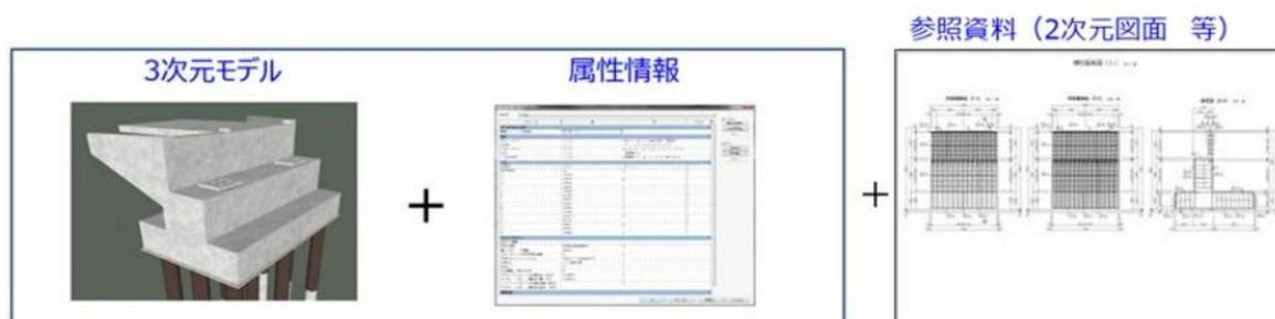
図1. 1 BIM/CIMモデルの構成
