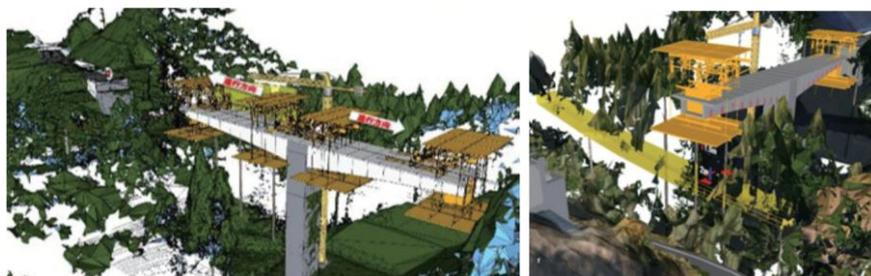
図 3. 13 架空線や立木との干渉をモデルで確認する例
