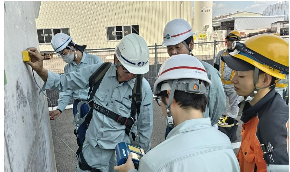
路盤部門 鉄筋位置の確認状況
