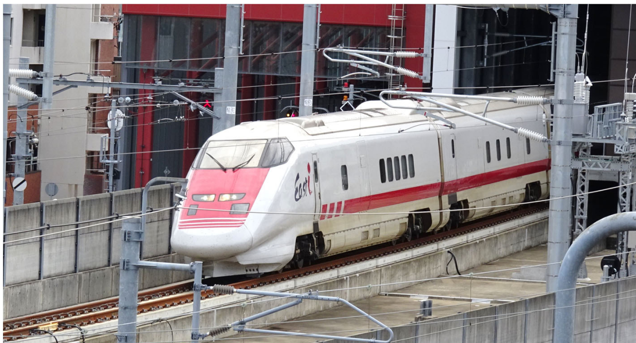
初入線する新幹線電気・軌道総合検測車（East-i）
