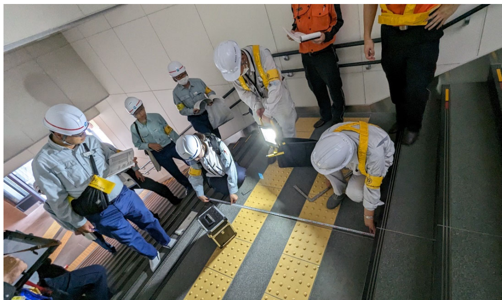
建築部門 階段寸法測定状況
