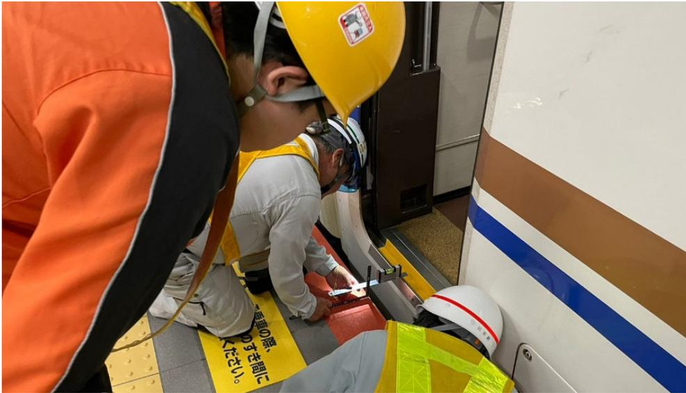
停工部門 ホームと車両の離隔計測状況
