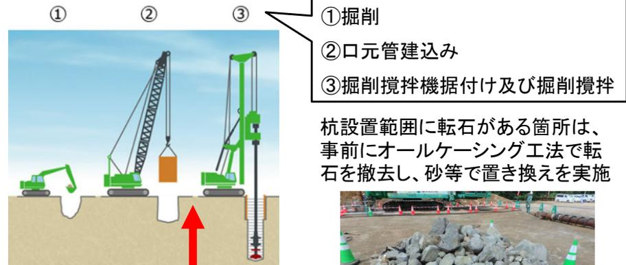
杭設置範囲に転石がある箇所は、事前にオールケーシング工法で転石を撤去し、砂等で置き換えを実施
