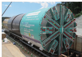
写真はSENS用シールドマシン。「SENS」はシールド(Shield)工法、ECL工法、山岳工法(NATM)といった既存のトンネル技術の特長を複合して開発したシステム(System)で、それぞれの頭文字から命名している
