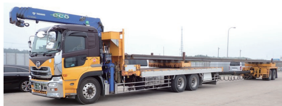
レールを港内輸送するポルトトレーラー
