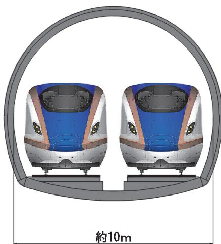
図 3-3-5 山岳トンネルのイメージ ※複線断面の場合
