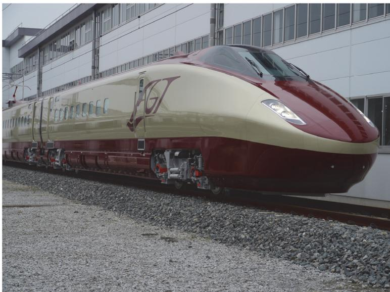
図 2-8 軌間可変新試験車両 (フリーゲージトレイン)
