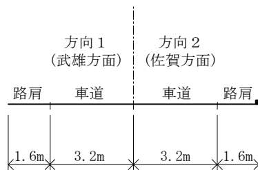
図 7.1.3-6(3) 現地調査地点の断面構成（道路交通振動／D 3 地点）
