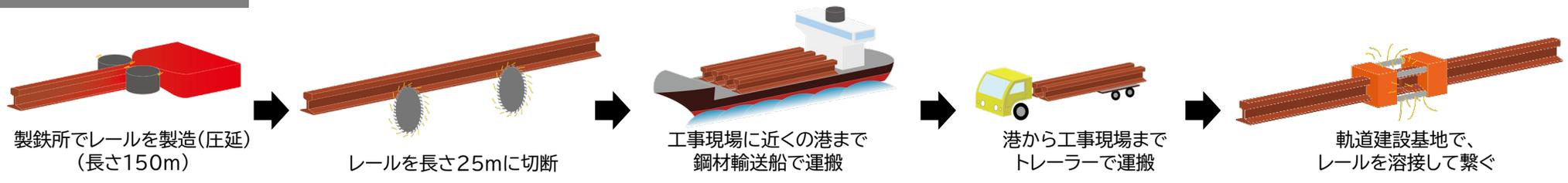
レールを長さ150mのまま、貨物列車に積載して輸送する方法が確立したこと、また、長万部駅は在来線と新幹線の工事現場が隣接しており、150mのレールを取り卸すことができることから、長さ150mのレールを貨物鉄道で輸送を行う。
