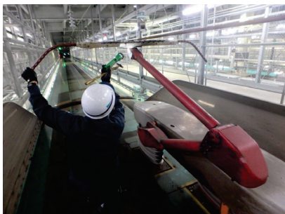
パンタグラフ(電気供給部)の検査 (提供:JR北海道)
