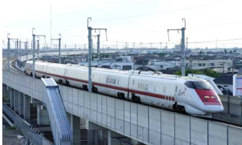
新幹線電気・軌道総合検測車 (East-i)
