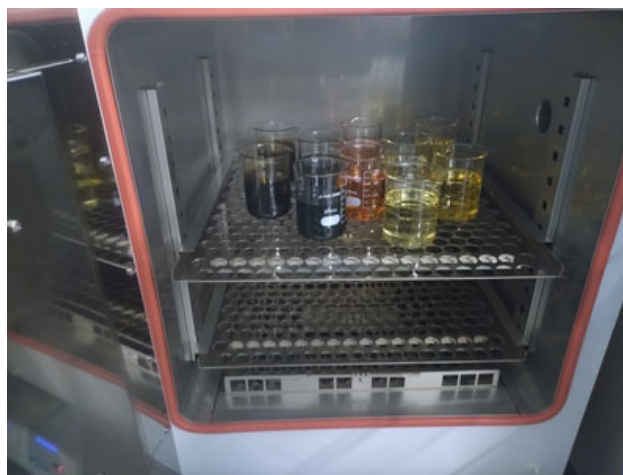
図2. 恒温槽を使用した強制酸化劣化油生成の様子
