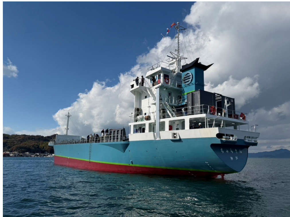
ちゅらさんに搭載したコンテナ型バッテリー
