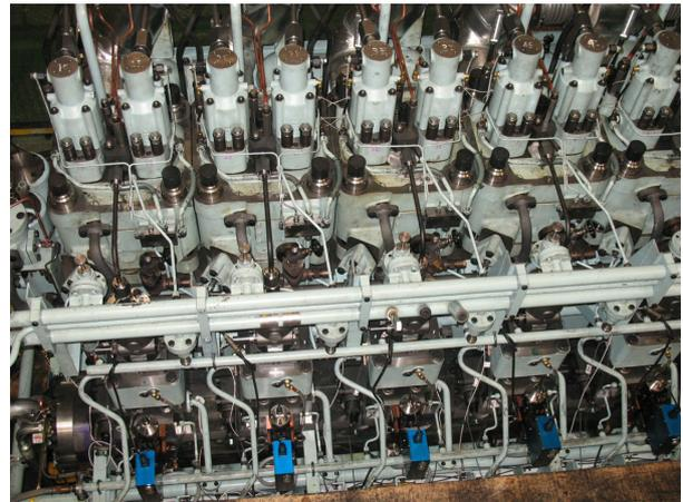
通常、機関の燃料噴射はカムによるものであるので、燃料噴射のタイミングは機関負荷によらず一定であるが、電子制御機関は燃料噴射をカムではなく油圧にて行う。またその油圧を制御する事により燃料噴射そのものを自由に変更する事ができる。
