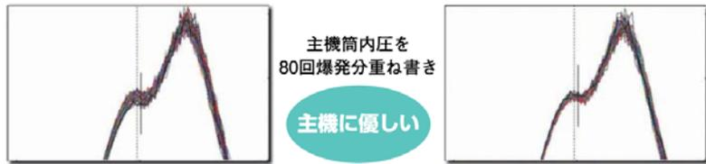
「通常制御」では、海が荒れると、修正動作がより多くかつ大きくなり、過剰な燃料投入が増える。「省燃費制御」では、範囲内の回転数変動を許容することで、過剰な燃料投入が解消される。計測精度と海象条件から大きな影響を受けることを考慮し、60分毎の実測データ(197件)を比較したところ、平均▲1.3%の省燃費効果が得られた。
