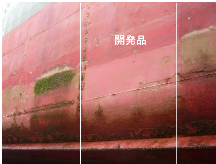
写真1 実船試験塗装写真(高速フェリー12ヶ月運航)
