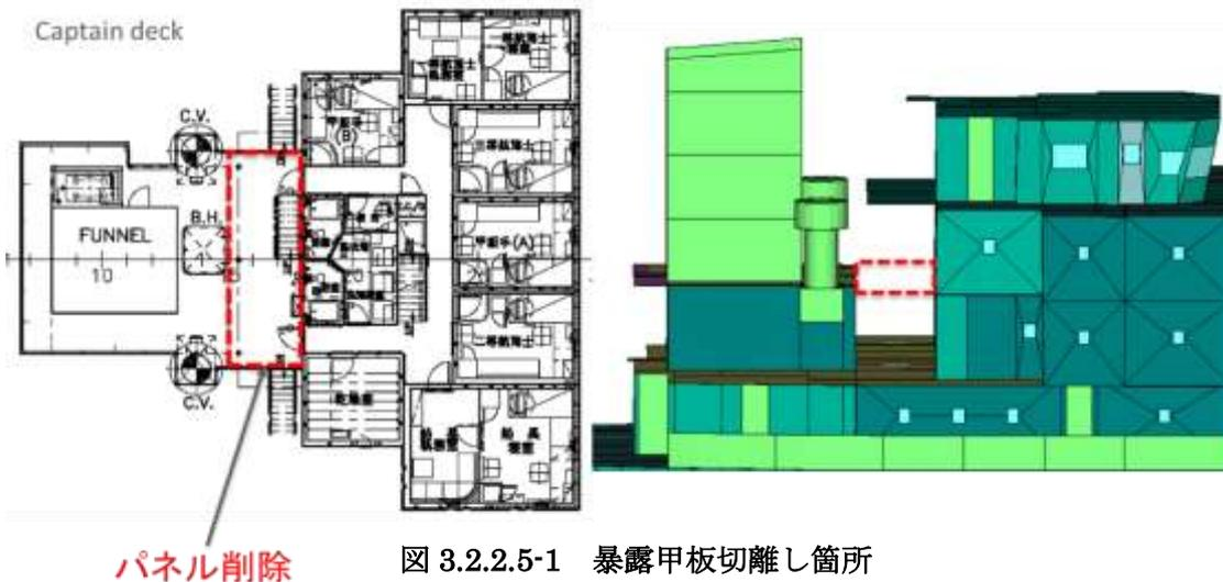
図 3.2.2.5-1 暴露甲板切離し箇所
