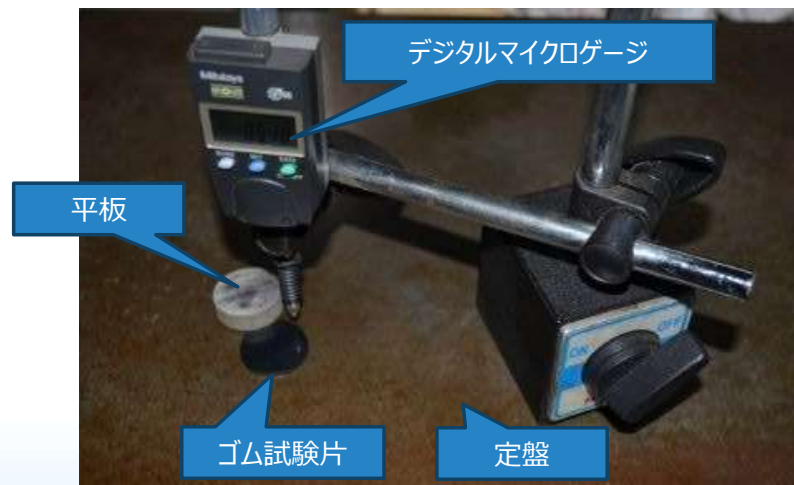
ゴム試験片の寸法計測
