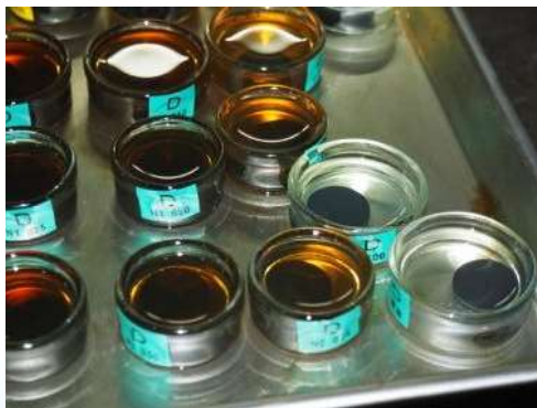
ゴム材料の浸漬試験
