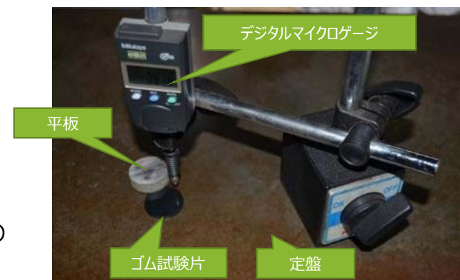
ゴム試験片の寸法計測
