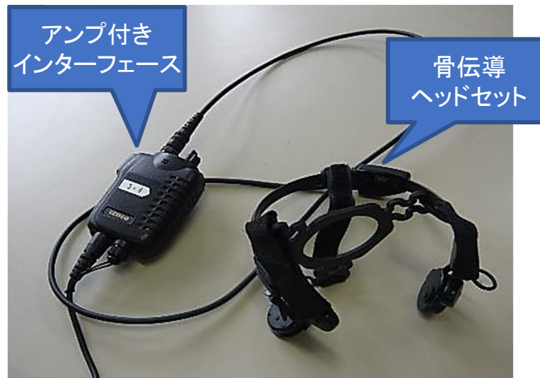
骨伝導ヘッドセット、及び、 アンプ付きインターフェース
