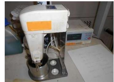
液体中で振動子を振動させ、振動子の粘性抵抗から粘度を推計する機器
