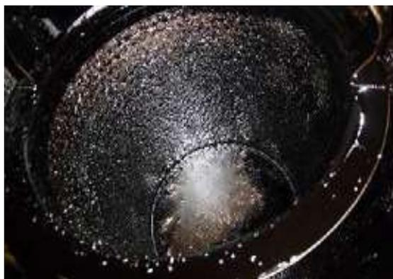
〔タンク底に沈殿していた海苔状のスラッジ〕
