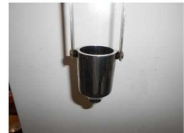
カップ内の液体が下部の穴から落ちきるまでの時間により粘度を推計する機器
