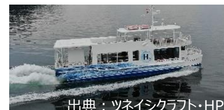
出典：ツネイシクラフト・HP 水素・軽油混焼小型旅客船「ハイドロびんご」
