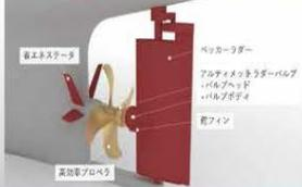
CFDによる船体性能推定に基づいた最適設計プロペラおよび電気エネルギーパッケージ
