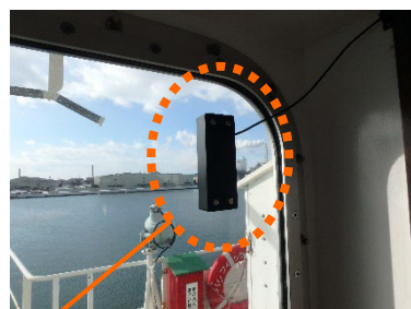
操舵室のガラス面(内側)に外部アンテナ(長さ100mm程度)を設置した様子
