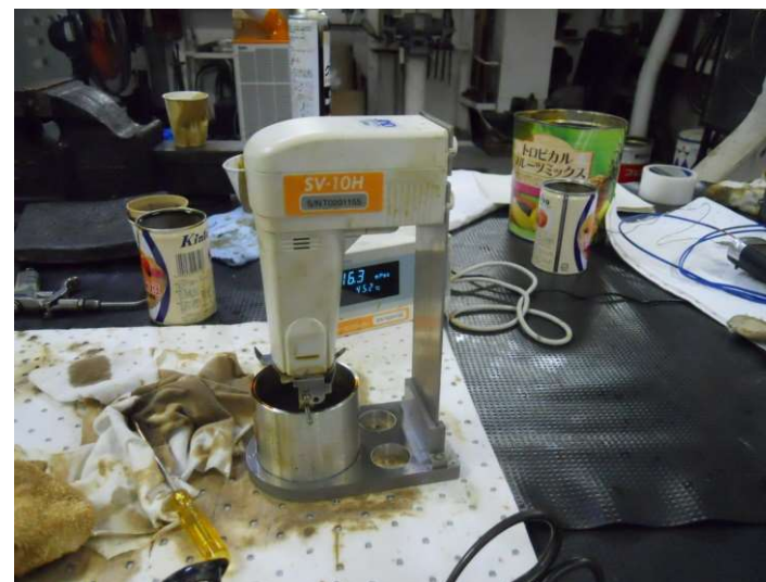
燃料油の粘度計測の様子
