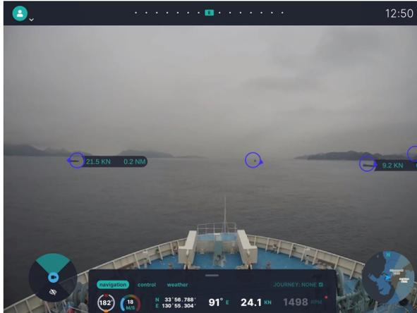
コンピュータビジョンを用い、昼夜を問わず、カメラ映像から海上の物体を検出、船舶の安全運航を支援します。AISを搭載していない小型船舶やブイ、漂流物の存在を検知して操船者に通知します。
