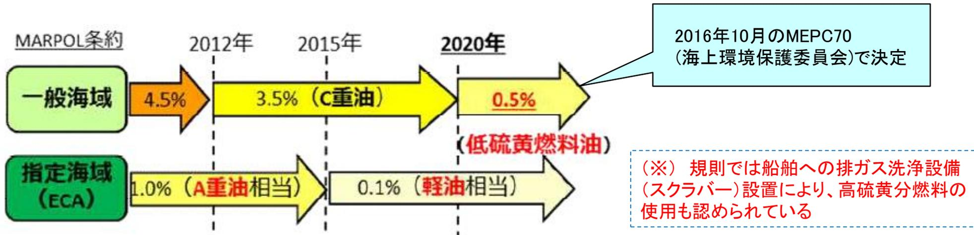
図1-1 マルポール条約による硫黄分規制
