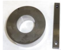
摩擦試験で使用する金属試験片
