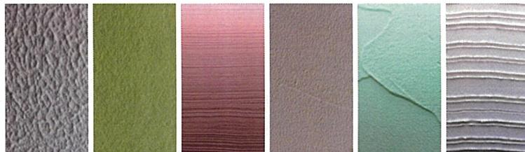
▲ローラー仕上げ ▲ローラー仕上げ ▲刷毛仕上げ ▲吹き付け仕上げ ▲コテ仕上げ ▲彫り仕上げ
