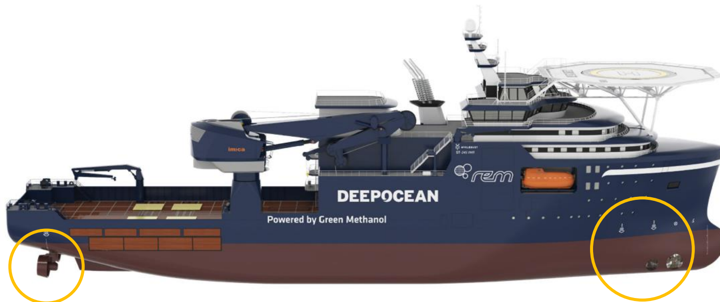
バウスラスト用 1500kW x1式 1800kW x1式 バウアジマススラスト用 1500kW x1式 いずれもRandax製電動機
