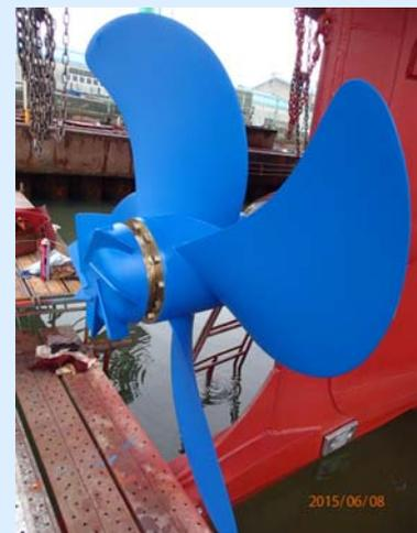
2015年6月 : CFRP製プロペラに換装
