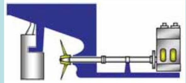
JG又はNKの承認を受けた手法に基づき、潤滑油の油分析等の定期的な管理によってプロペラ軸系の潤滑状態が適切に管理された場合、通常は5年間のところ、最大10年間(NKでは異常が見られるまで)軸の抜き出し検査が延期される。
