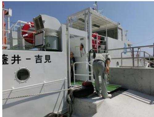
① **バリアフリー昇降タラップ**：左の写真が閉じた状態で、右が開いた状態。**昇降式**なので、潮の干満にかかわらず、タラップは傾斜のない水平状態にできる。
