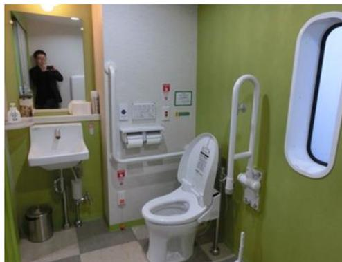
③ **バリアフリースイートイレ**： **トイレ内で車椅子の転回が可能**。トイレの外側にAED（自動体外式除細動器）を設置。トイレの内装、外装は清潔感のある明るいデザインとした。手洗と鏡は低い位置に配置。
