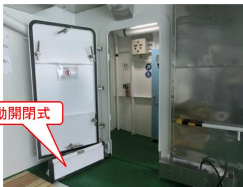
④ **段差解消式風雨密扉**：コーミング部分は**自動開閉式**。左の写真が閉じた状態。右が開いた状態。扉を超えて左奥が自動ドアで、その中がバリアフリースペース。
