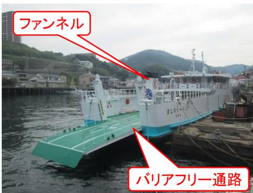
① **大型ランブドア**：幅5mで大型バスの搭載も容易。バリアフリー通路は右舷、ファンネルは左舷に配置。
