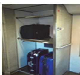
荷物置き場の設置
