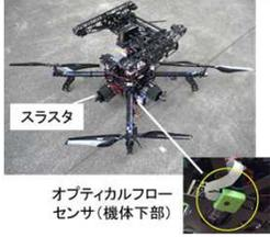
橋梁やその付帯構造の検査を低コスト化・高度化するために、検査用ドローンの機体制御手法の改良やロボット計測技術の応用により、コンクリート構造物の劣化箇所の詳細検査技術等を開発しています。
