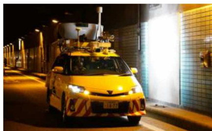
道路トンネルのひび割れデータ取得状況
